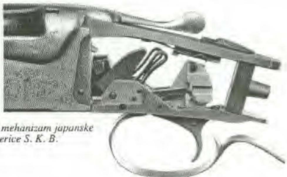
Blic udarni mehanizam japanske bokerice S. K. B.
